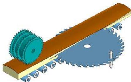
Чтобы избежать этой проблемы **существует опция** в виде дополнительной ребухи на выходе из делительного узла. Особенно, если предполагается использование станка **CM-500** самостоятельно, отдельно от линии.
