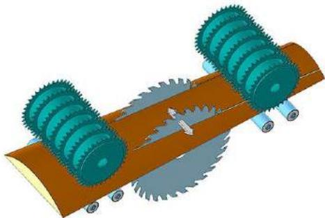
**КМ-400** имеет одну приводную ребуху на входе и одну приводную ребуху на выходе из станка, за счет этого он может использоваться отдельно от линии как самостоятельный кромкообрезной станок.
