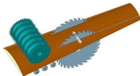
**КМ-500** более бюджетный вариант в сравнении с **КМ-400** за счет конструктивных особенностей, но при непрерывной подаче заготовки стык-в-стык отлично выполняет обрезку кромок на горбыле.
